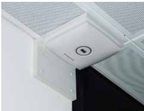
Figuur 1. WiFi access point (onder), in dit geval gecombineerd met een bewakingscamera (boven). Het access point verzamelt informatie van gebruikers en stuurt die draadloos verder naar het meer centrale deel voor verdere verwerking.
